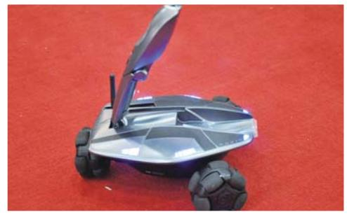
Rovio可八向移动的机器人摄像机，通过Wi-Fi无线网络控制
